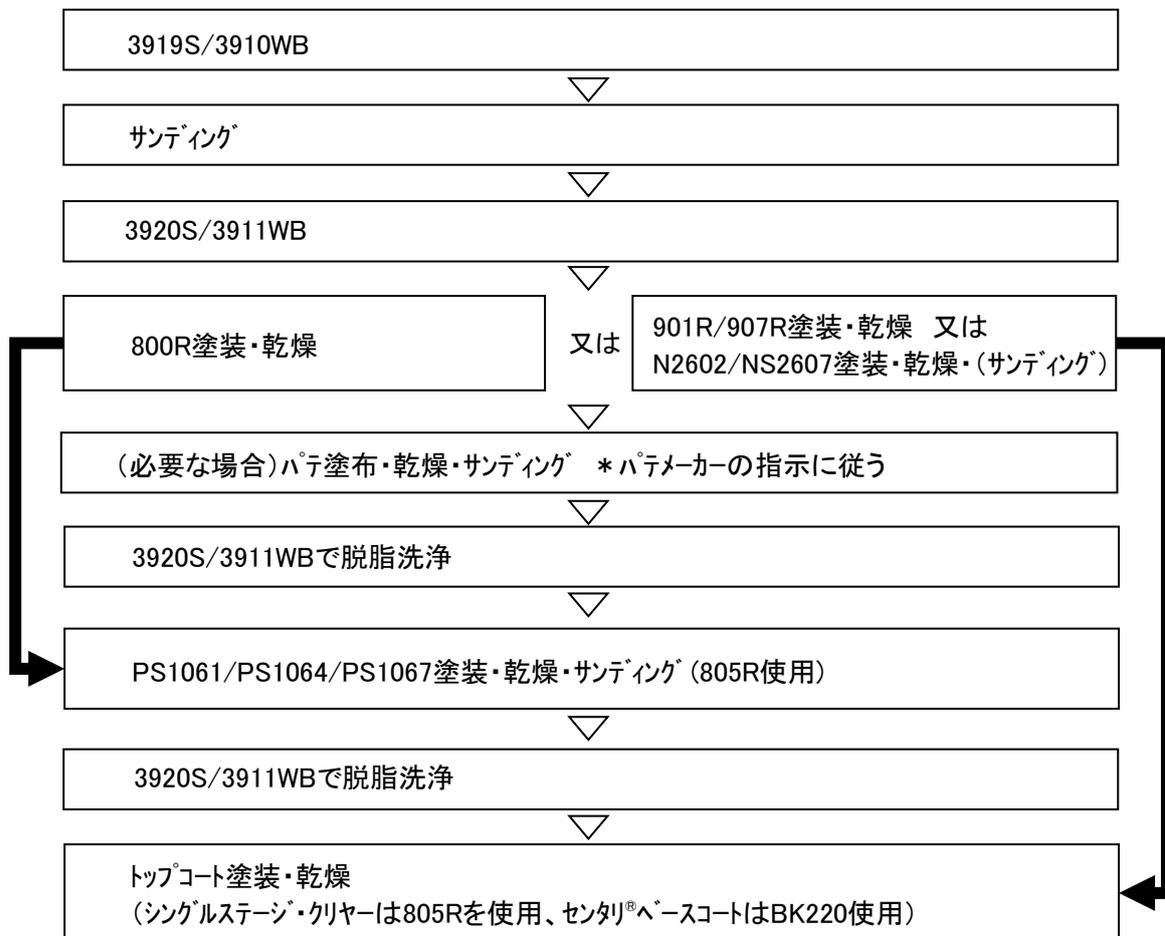
\* 足付け・サンディング時に素地が露出した場合、800R、901R/907R又はNS2602/NS2607を塗装する。
